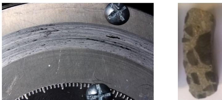
Figure 1: Etat de surface du disque en alliage d'aluminium (gauche) après contact avec un patin en béton (droite)
